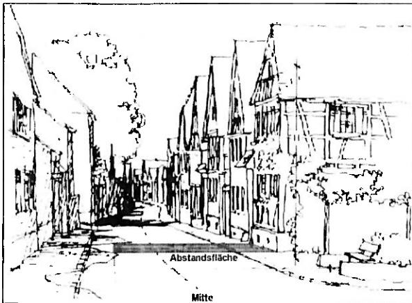
Abb.: Unterschreitung der Abstandsfläche bei historischer Straßenrandbebauung
