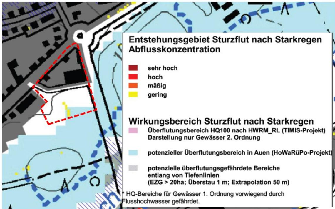
Ungefähre Lage des Plangebietes (rot gekennzeichnet) in der Karte 5 der Gefährdungsanalyse Sturzflut nach Starkregen (Quelle: Landesamt für Umwelt, Gefährdungsanalyse Sturzflut nach Starkregen, Karte 5; 2018)
