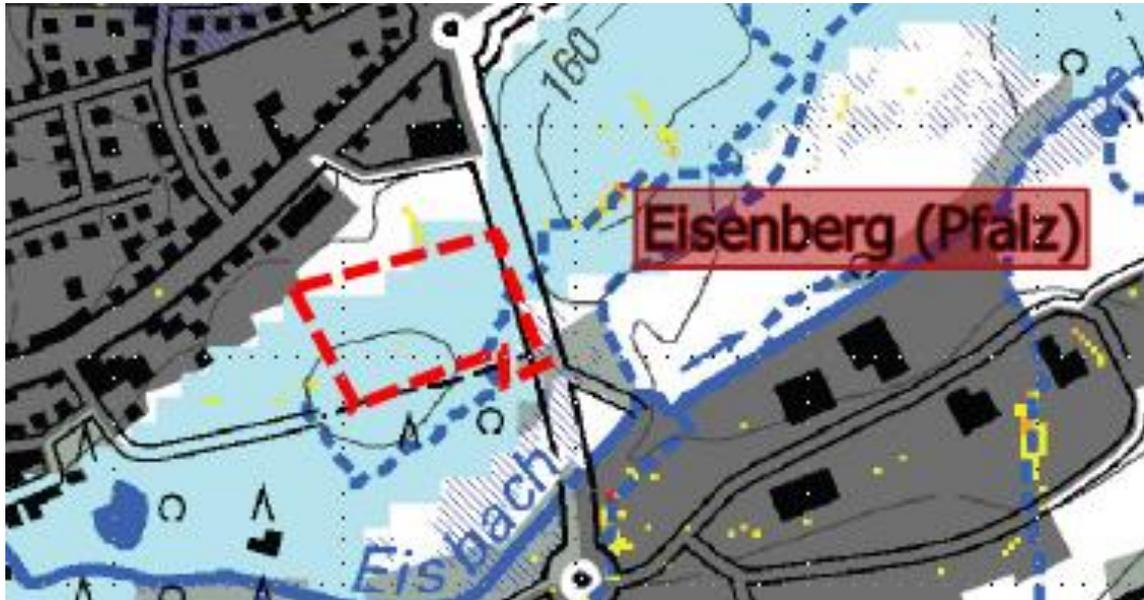
Ungefähre Lage des Plangebietes (rot gekennzeichnet) in der Karte 5 der Gefährdungsanalyse Sturzflut nach Starkregen (Quelle: Landesamt für Umwelt, Gefährdungsanalyse Sturzflut nach Starkregen, Karte 5; 2018)
